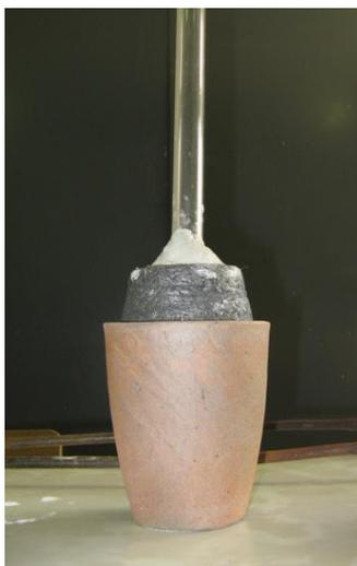
Рисунок 2 – Экспериментальная установка для восстановительного обжига брикета из отхода
